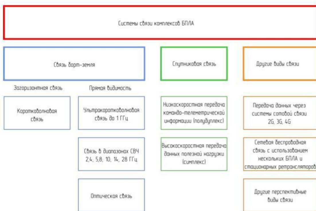
Рис. 1: Системы связи комплексов БПЛА
